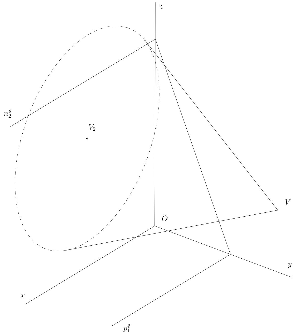
**Příklad 11:** Sestrojte parabolický řez na rotačním kuželi rovinou  $\omega$ , znáte-li její stopu.
