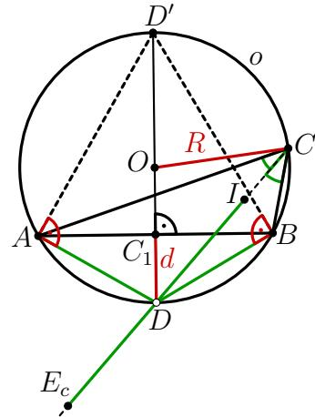
Při označení  $d = |C_1D|$  pak podle Eukleidovy věty o odvěsně platí rovnost  $|DA|^2 = |DB|^2 = 2Rd$ , a proto rovněž platí
