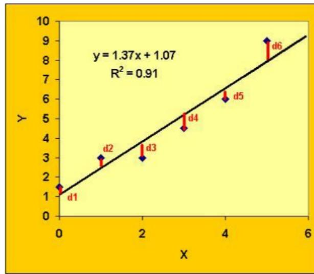
Ukažme si použití této metody v nejjednoduším případě, kdy máme dáno  $n$  bodů  $([x_1, y_1], \dots, [x_n, y_n])$  a hledáme přímku, která nejlépe *vystihuje* rozložení těchto bodů.
